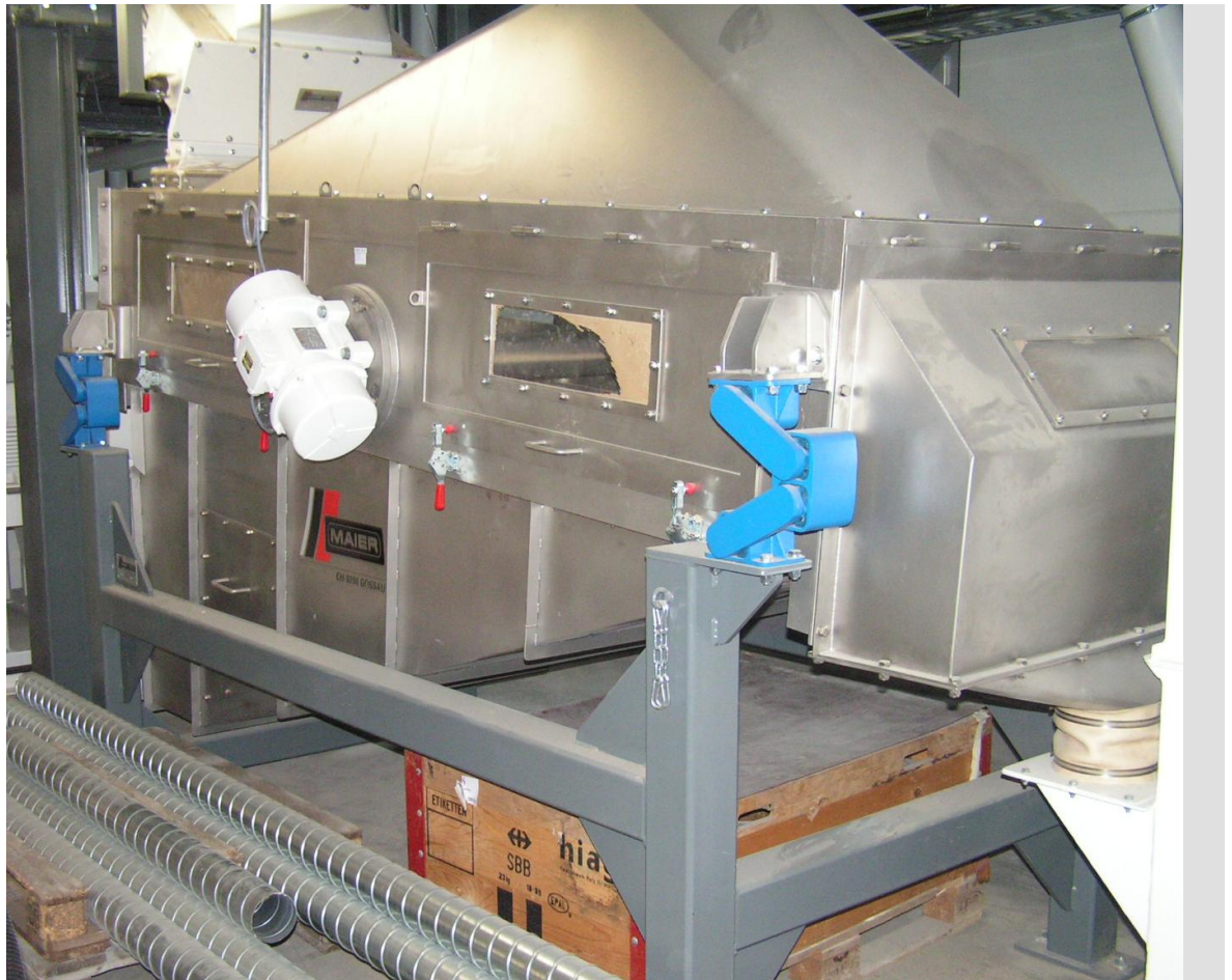
Rüttelkühler der Futtermittelanlage bei Multiforsa AG in Auw.
